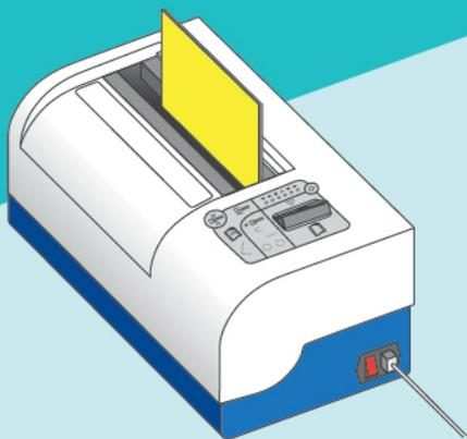
**1** Blattstapel in das Gerät stellen. Streifenbreite wird angezeigt.
