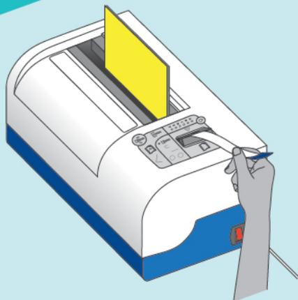
**2** Copy Strips einführen. Bindevorgang wird ausgelöst.
