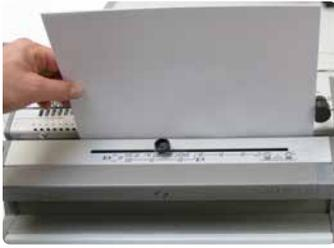
Vertikales Stanzen erhöht die Präzision beim Stanzvorgang.
