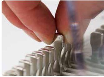
Die QSA-Technologie (Quick Size Adjustment) erlaubt das sekundschnelle Ausschalten der Stanztempel, wodurch Papierformate einfach und schnell gewechselt werden können.
